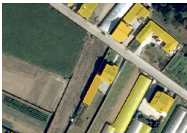
Figure 2. Áreas de implantação de edifícios em Póvoa de Varzim (AMU), Mask R-CNN
