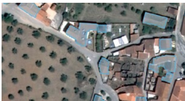
Figure 4. Áreas de implantação de edifícios em Torres Novas (APR), Mask R-CNN
